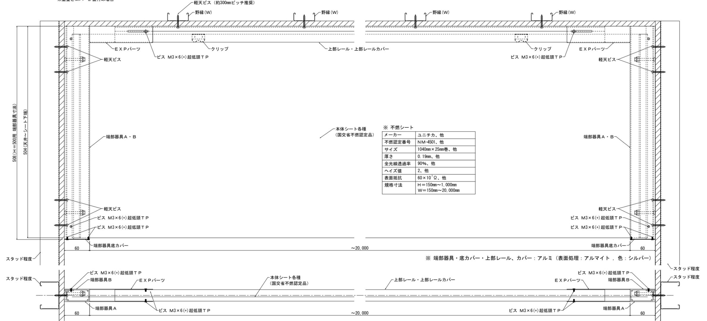
※ 端部器具・底カバー・上部レール、カバー：アルミ（表面処理：アルマイト、色：シルバー）
